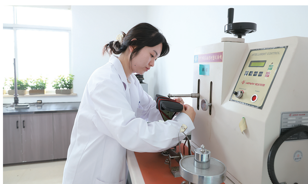
在中轻检验认证（浙江）有限公司城北分中心内，工作人员正在检测鞋底耐磨程度。
