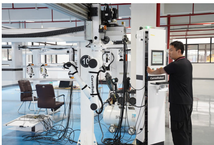
工作人员正在对柔性机械臂开展性能测试。
