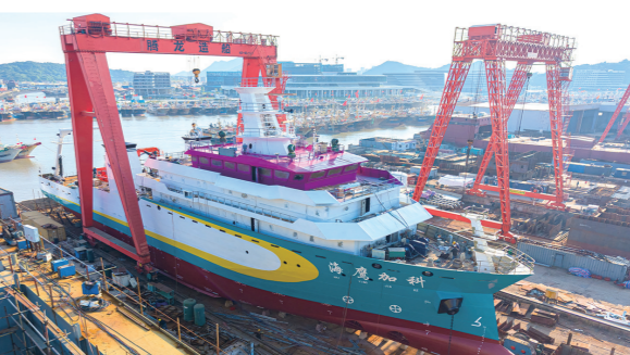
2026年4月底:披上战袍。船体涂装作业完成。
