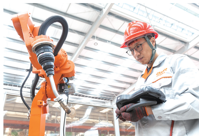
王洋正对公司自主研发的智能焊接系统进行应用调试。
