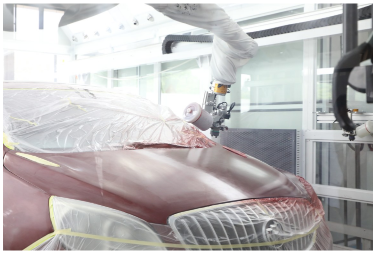
智能柔性机器人正在开展喷涂作业。(图片由企业提供)
