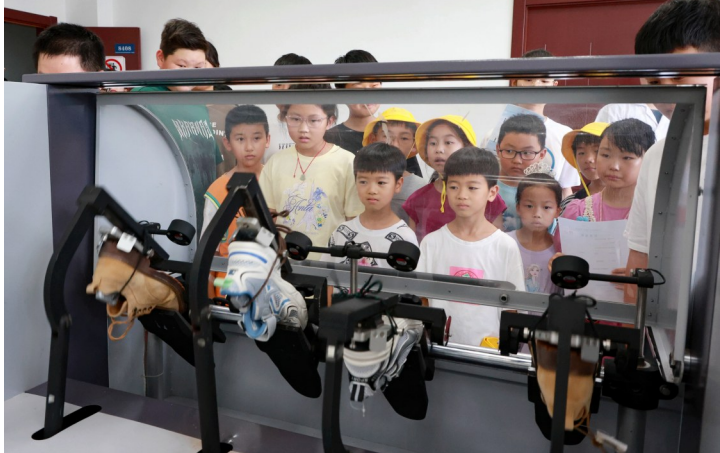
工作人员对鞋子进行耐折性能测试。
