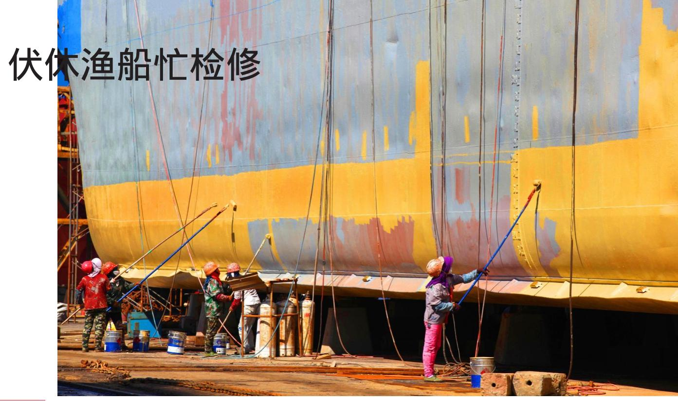
6月6日,松门合兴船厂维修船坞一片繁忙,工人师傅正在给渔船做电焊加固、更换部件、除锈涂漆等维修保养工作,做好安全检修和隐患整改,做到渔休船不休。
