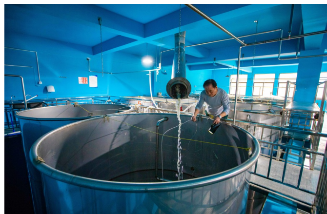
酿酒师傅正在测酒精发酵罐内的温度。
