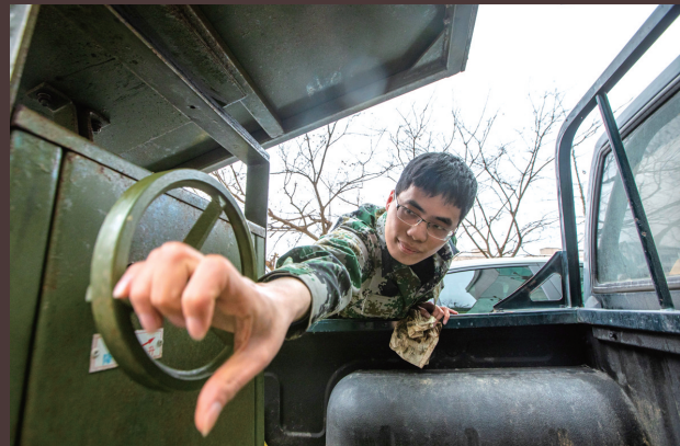
按照预测的云层高度，调整发射架的仰角。
