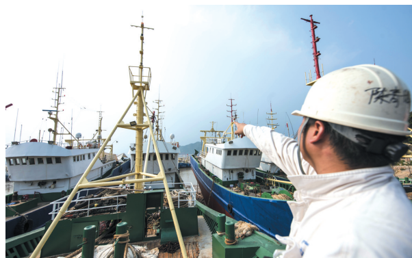
验船师检查渔船的指示灯，指示灯分为航行灯、作业灯等，这些灯具必须齐全。
