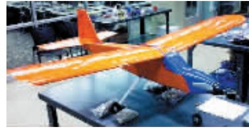
【3D打印无人飞机,时速可达45英里】美国弗吉尼亚大学工程系研究人员最新制造了一架3D打印无人飞机,巡航时速可达45英里,机翼宽6.5英尺,是由打印零件装配构成。设计和建造这架3D飞机用时4个月,成本大约为2000美元。
